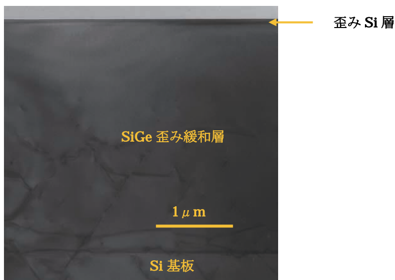
図 1 : SiGe 歪み緩和層の断面 TEM 像
